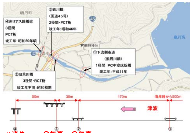
図3 荒川橋周辺の橋梁の状況
