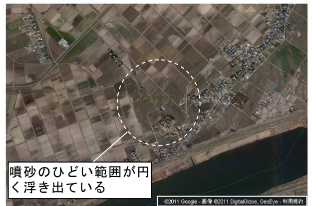
写真3 六角地区の噴砂発生状況 2)
